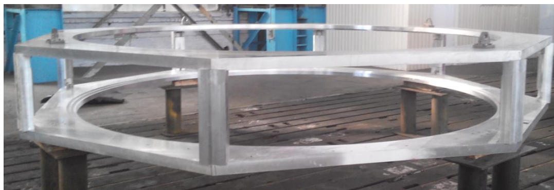
Рис. 5. Сварная металлоконструкция «Шайба»
