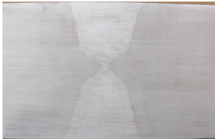
Рис. 3. Макроскопический анализ сварного соединения
