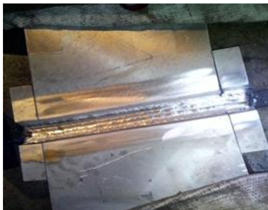
Рис. 4. Заполнение разделки при сварке металлоконструкции «Шайба»
